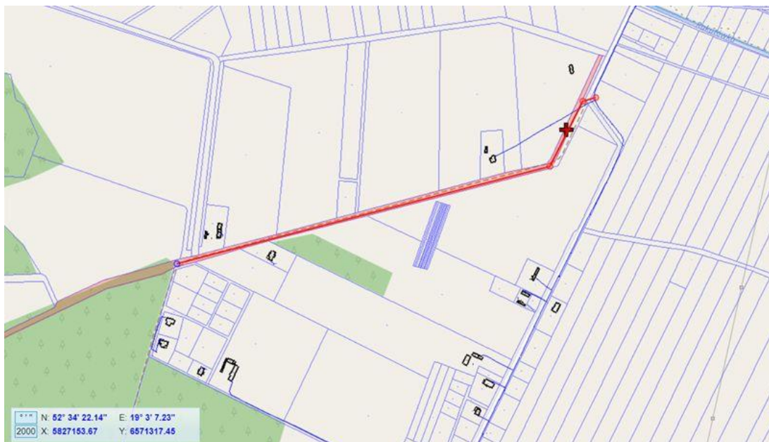
Rysunek 15. Ludwinowo (działka nr 136/3, 191 obręb Ludwinowo; Łagiewniki, dz. nr 145/2 obręb Łagiewniki) – sieć PE DN110 długości około 1031 mb Źródło: Geoportal Powiatu Włocławskiego
