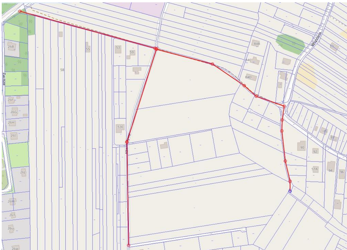
Rysunek 21. Warząchewka Polska (od ulicy Kolejowej do ulicy Wspólnej wraz z ulicą Alternatywy) – sieć PE DN110 długości ok. 1400 m Źródło: Geoportal Powiatu Włocławskiego
